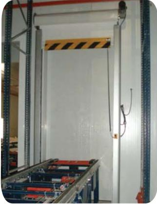
Puerta rápida enrollable de congelación en combinación con sistema automatizado de transporte de palets.
