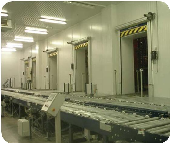
Puerta rápida enrollable en combinación con sistema automatizado de transporte de palets
