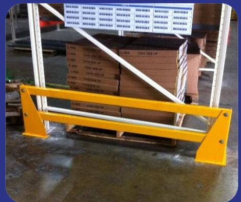
Los protectores esquineros con barras, protegen a la columna de los marcos de golpes ocasionados por el transito de montacargas en pasillos longitudinales y transversales.
