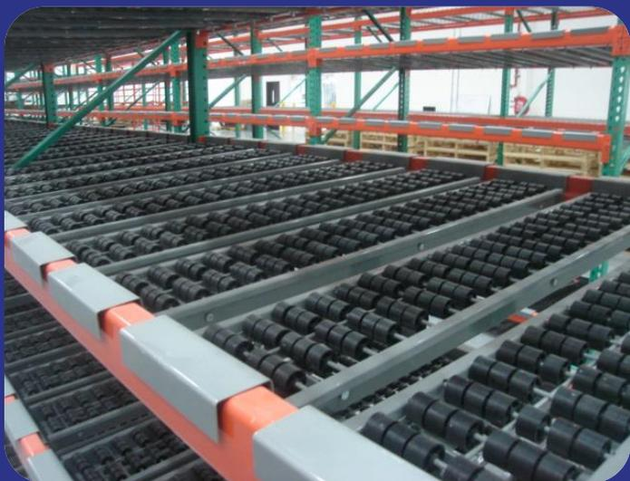
Este sistema se utiliza para el almacenaje manual de cargas medias y pesadas, nuestros bastidores del rack surtidor, tipo rueda de patin o de rodillo se ajustan a tus necesidades.
