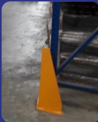
Los protectores esquineros, protegen a la columna de los marcos de golpes ocasionados por el transito de montacargas en pasillos longitudinales y transversales.
