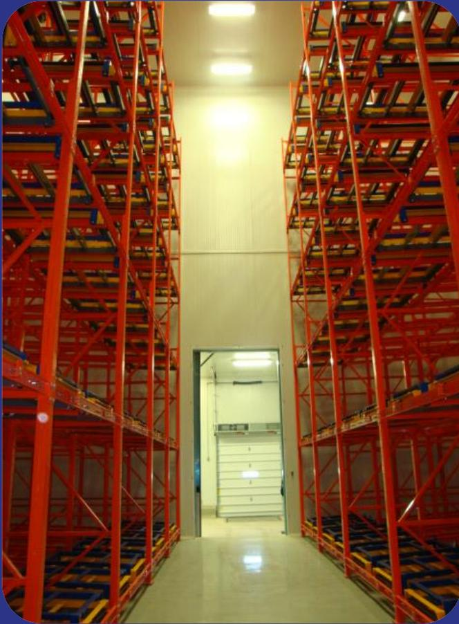
Es un sistema de almacenamiento con un mecanismo que permite empujar las tarimas del frente hacia el fondo del rack. Permite llevar inventario de Última entrada-Primera salida, y puede tener hasta 5 tarimas de profundidad de túnel.
