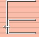
Guías de 2-1/4" de profundidad diseñadas a sujetarse directamente a la estructura del vano permitiendo un sellado perfecto
